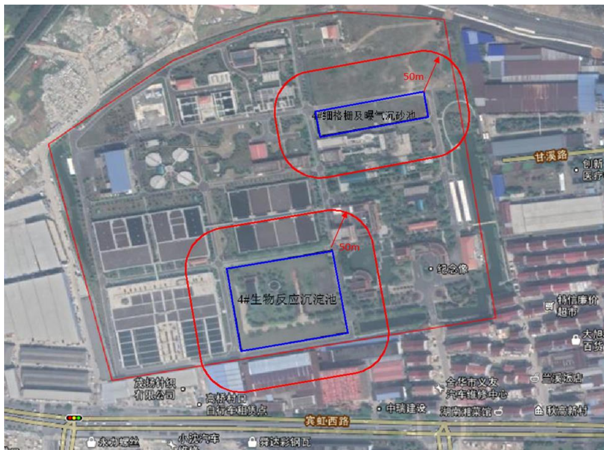
图 6.1-5 本工程卫生防护距离包络线示意图
